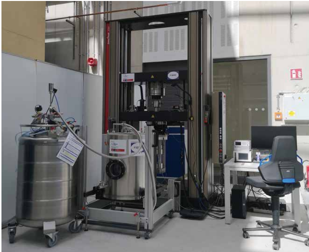
Zugprüfmaschine für Messungen in Flüssig-Stickstoff bei -196^{\circ}\text{C} am Faserinstitut Bremen
