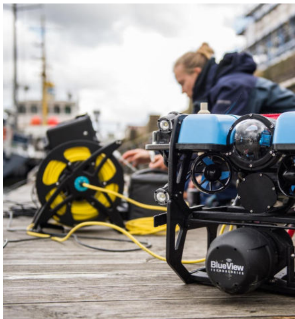
Das Zusammenspiel verschiedenster Sensorsysteme hat das DLR-Institut im Rahmen des Projekt MARLIN (Maritime Awareness Realtime Instrumentation Network) im Fischereihafen getestet. Eines der vielen Elemente, die zu einem Lagebild beitragen, ist ein ferngesteuertes Tauchfahrzeug mit hochauflösender Kamera Foto: DLR
