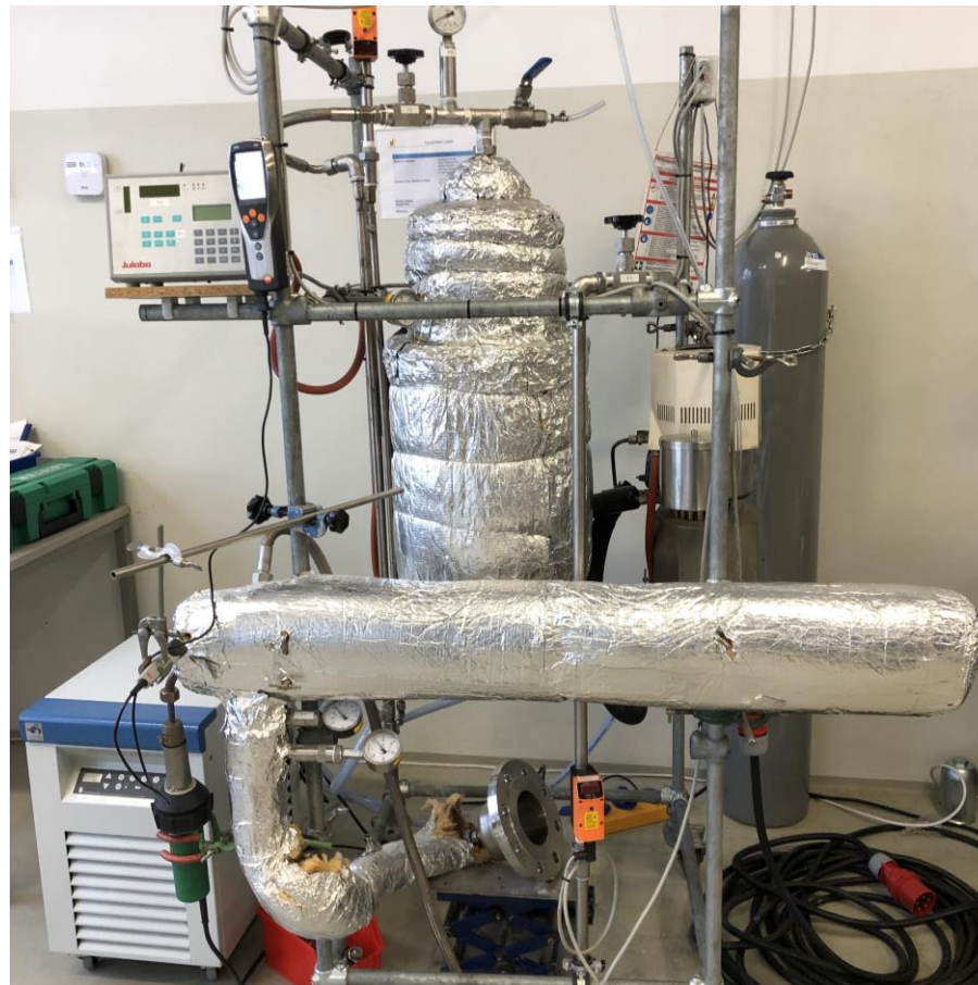
Technikumsanlage zur CO 2 Erfassung und Speicherung im ttz Bremerhaven
