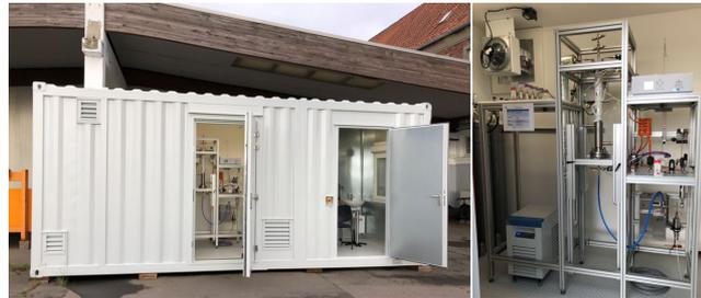
Abbildung Die E-Fuels Anlage aufgebaut im explosionsgeschützten Container
