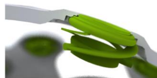
Schnitt durch den Elektrodenträger (grau) Elektrodenhalter (grün)
